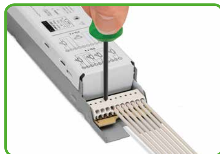
Извлечение проводника при помощи инструмента для демонтажа Ø 1,0 мм
